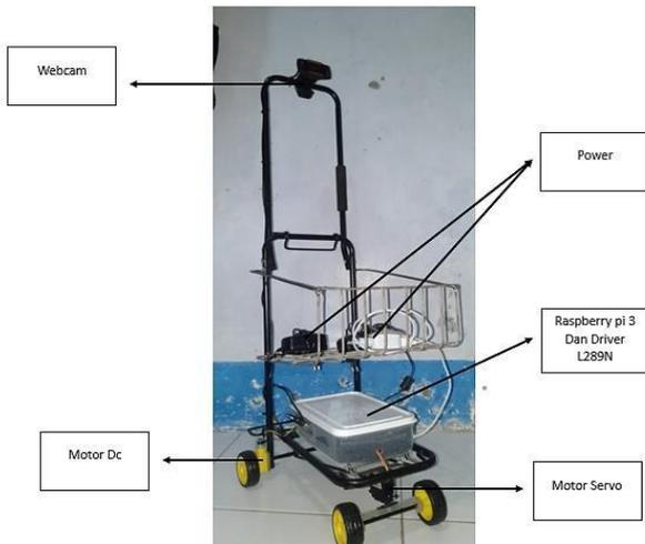
Gambar 9. Hasil Perancangan Sistem Mekanik
