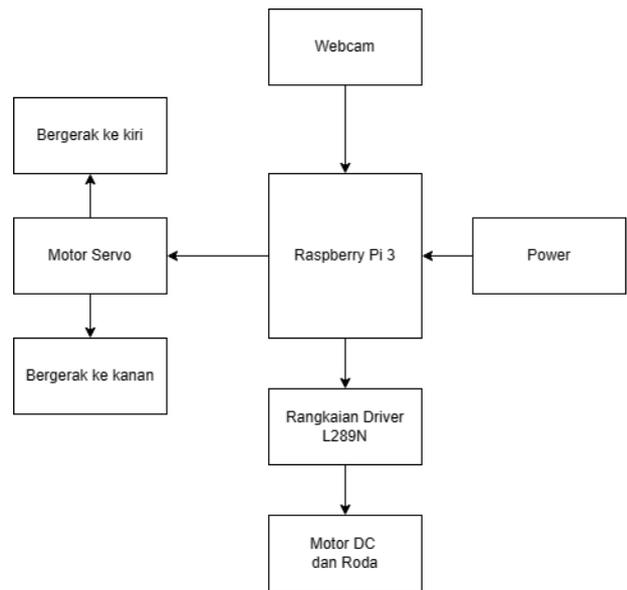
Gambar 4. Blok Diagram
