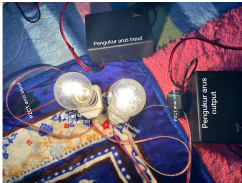
Gambar 6. Pengujian dengan Beban 40 Watt
