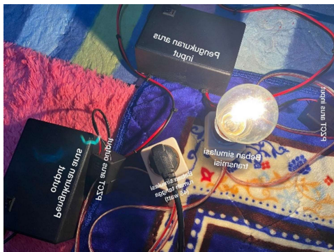
Gambar 8. Pengujian dengan Beban 45 Watt
