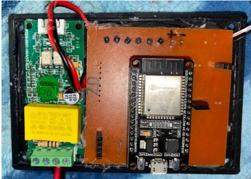
Gambar 4. Tampak Dalam perakitan Board Pada Alat
