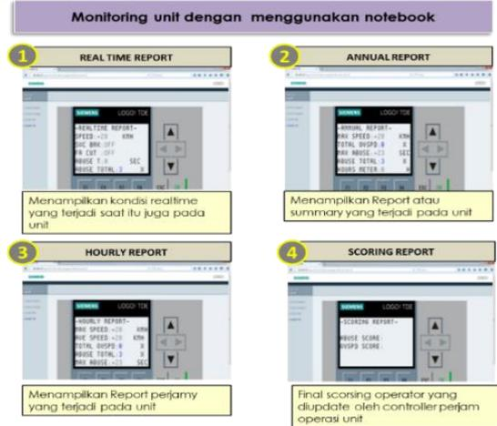
Gambar 9 Proses monitoring *realtime* parameter pada modul dengan menggunakan *webservice* pada PLC
