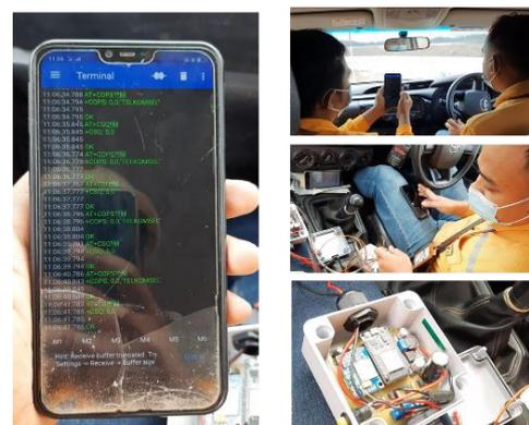
Gambar 5. Survei kekuatan signal GSM pada SMS Module PLC dengan menggunakan aplikasi Bluetooth Serial Monitor
