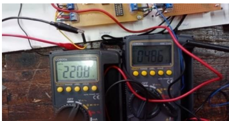
Gambar 21. Hasil Pengujian Output pada modul full-bridge
