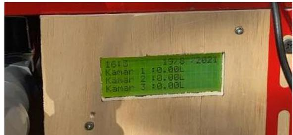
Gambar 12. Tampilan LCD 20x4 pada alat
