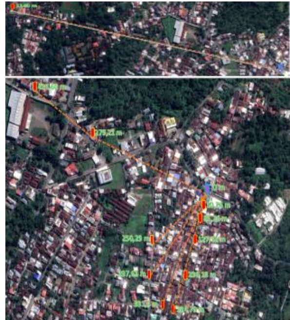
Gambar 11. Lokasi Pengujian Komunikasi Antar Node di Kawasan Padat Penduduk (non line of sight)
