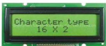
Gambar 7. LCD 16x2 (Sumber: Sinaulan, 2015)
