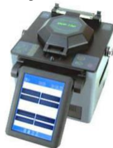
Gambar 2. Alat penyambungan dengan metode fusion splicer
