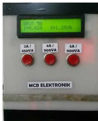
Gambar 6. MCB elektronik pada beban nol dengan 3 variasi beban
