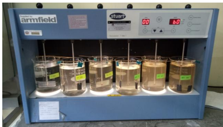
Gambar 1. Pengaturan uji korosi dengan pengadukan
