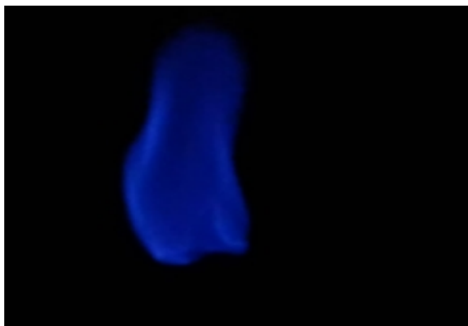
Gambar 4. Nyala api biogas
