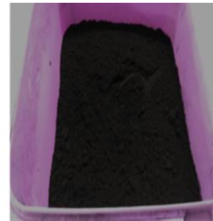
Gambar 15 Pengaruh waktu pemanasan pada suhu 200°C terhadap peningkatan nilai kalor batubara Gambar 16 Batubara sesudah proses penurunan kadar sulfur dan abu, nampak lebih hitam pekat
