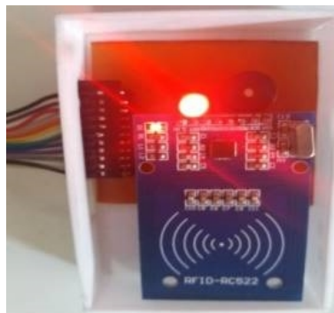
Gambar 3. Perangkat RFID reader 2 (zona tidak aman)
