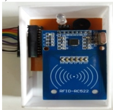
Gambar 2. Perangkat RFID reader 1 (zona aman)
