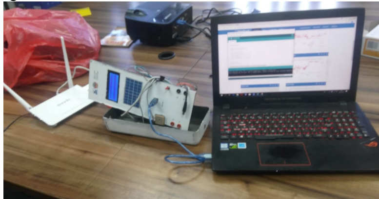
Gambar 9 Kondisi Saat Pengujian Data Logger Alat Ukur Parameter Solar Panel
