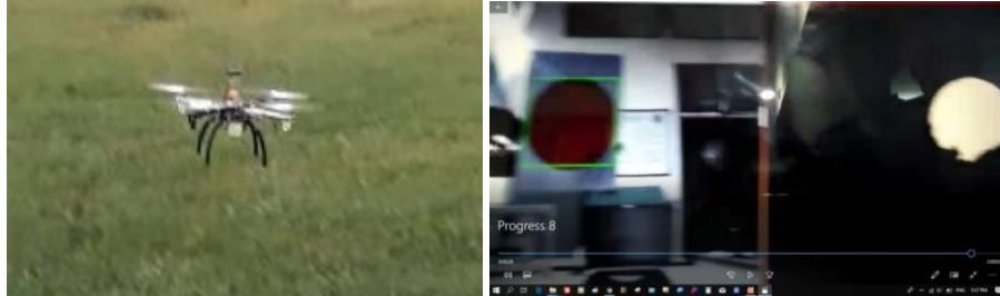
Gambar 6 (a) Drone yang telah dilengkapi dengan kamera dan video sender (b) Image Processing untuk mendeteksi dan mengikuti objek/target
