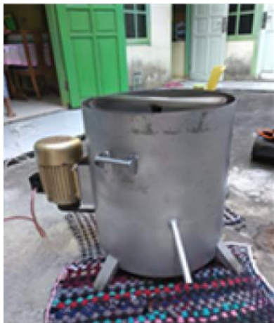
Gambar 7. Produk Akhir Modifikasi Alat Peniris Minyak Bawang Goreng
