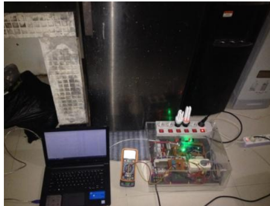
Gambar 1. Pengujian Beban Dispenser
