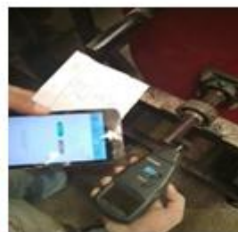
Gambar 4. Pengukuran rpm dengan Tachometer
