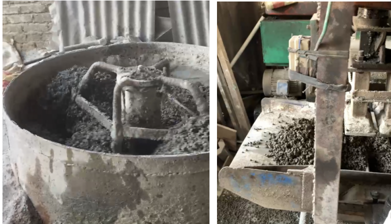
Gambar 3. Proses Produksi Paving Block
