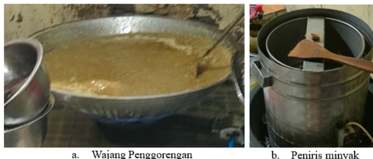
Gambar 2. Alat Penggorengan dan Peniris Minyak
