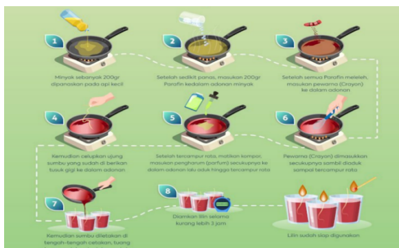
Gambar 4. Langkah yang dilakukan dalam pengolahan minyak jelantah menjadi lilin
