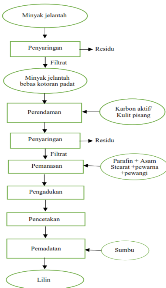
Gambar 1. Diagram alir pengolahan minyak jelantah menjadi lilin
