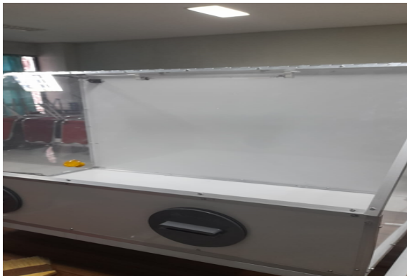
Gambar 1. Perakitan Tempat Isolasi Bakteri
