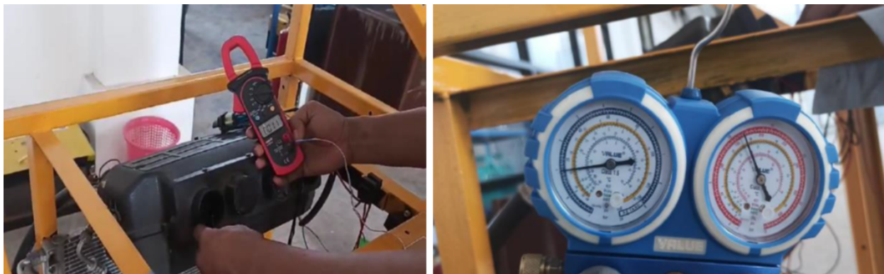
Gambar 4. Pengujian suhu dan tekanan sistem alat peraga air conditioning alat berat
