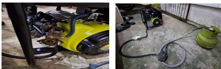
Gambar 2. Pembuatan dan pengujian Konverter Kit Genset
