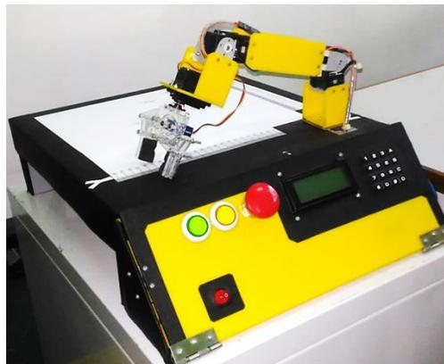
Gambar 8. Hasil akhir rancang bangun prototipe robot manipulator 5 DOF
