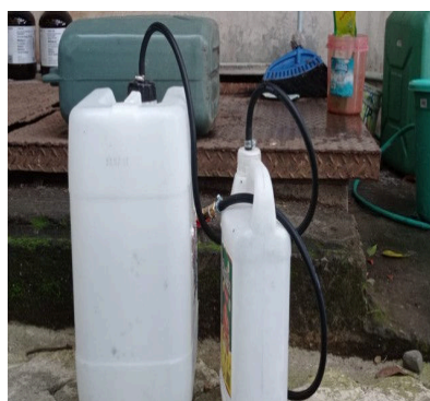
Gambar 5. Digester pembuatan biogas dari Kotoran Sapi
