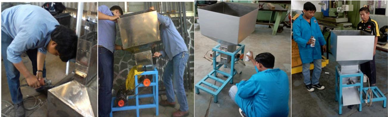
Gambar 3. Pembuatan mesin pemotong buah markisa
