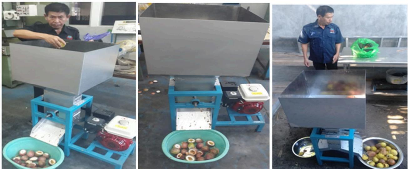
Gambar 4 .Pengujian Mesin Pemotong Buah Markisa
