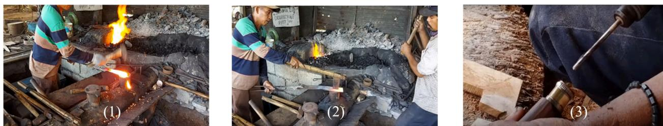
Gambar (1) Workshop Panre Tutu untuk melaksanakan aktivitas pengerjaan benda kerja (2) Proses pemotongan benda kerja yang dilakukan saat besi dalam kondisi panas, dan (3) Proses penggunaan bor dengan hanya menggunakan bor tangan
