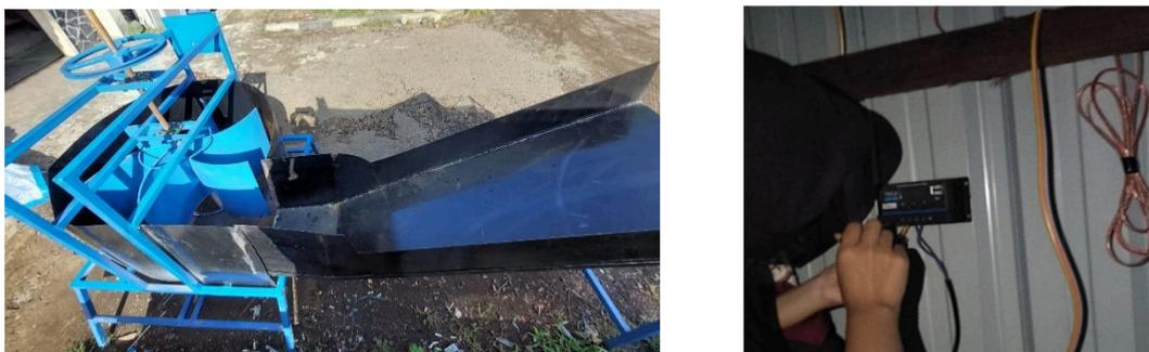
Gambar 4. Hasil pembuatan dan perakitan komponen mekanikal-elertkikal PLMH
