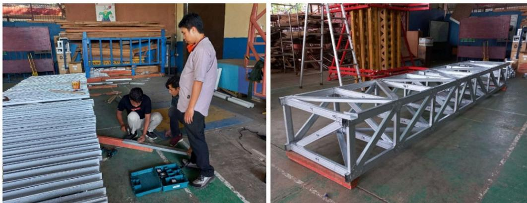
Gambar 2. Pembuatan struktur jembatan di laboratorium konstruksi
