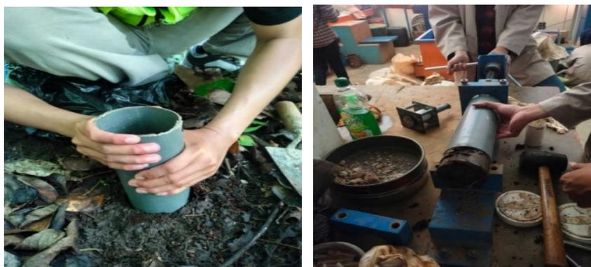
Gambar 1. Pengambilan contoh tanah di lapangan dan pengujian contoh tanah di laboratorium pengujian tanah
