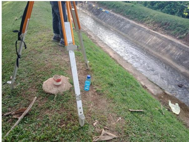
Gambar 2. BM.05 di tepi saluran irigasi sebagai titik awal koordinat pengukuran Total Station
