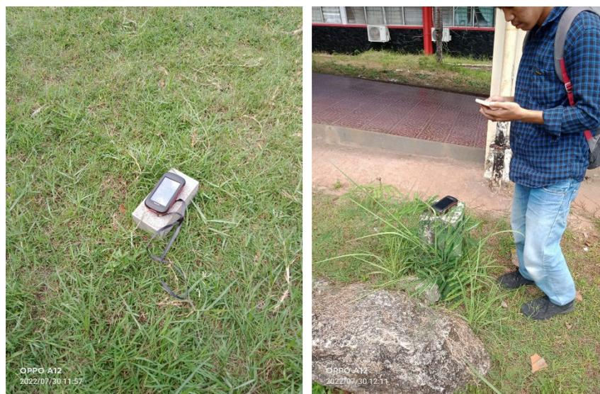
Gambar 3. Pelaksanaan *static tracking* titik poligon menggunakan alat GPS *handheld*
