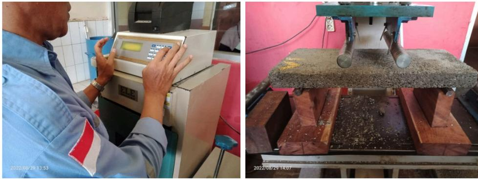
Gambar 4. Pengujian kuat tarik lentur pelat beton menggunakan alat *bending test machine*
