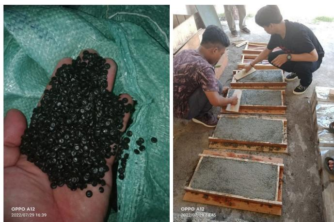
Gambar 1. Material biji plastik LDPE dan pembuatan sampel uji
