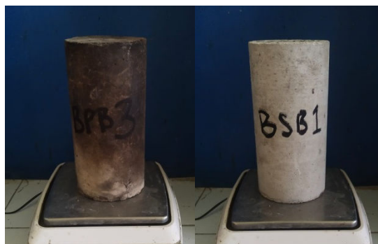
Gambar 2. Beton sebelum dibakar dan setelah dibakar
