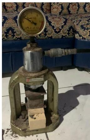
Gambar 2. Pengujian Kuat Tekan Bata Ringan
