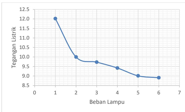
Gambar 4. Grafik hubungan tegangan listrik terhadap jumlah beban lampu
