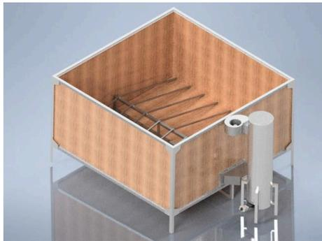
Gambar 2. Mesin pengering tampak dari atas tanpa penutup
