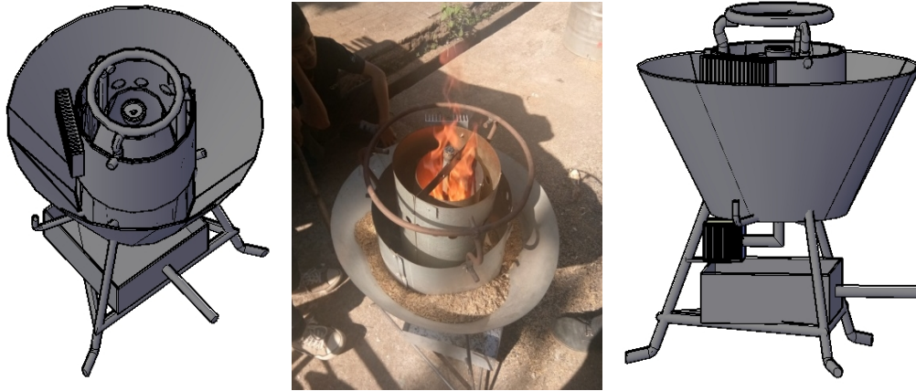
Gambar 3. Hasil modifikasi kompor biomassa sekam padi
