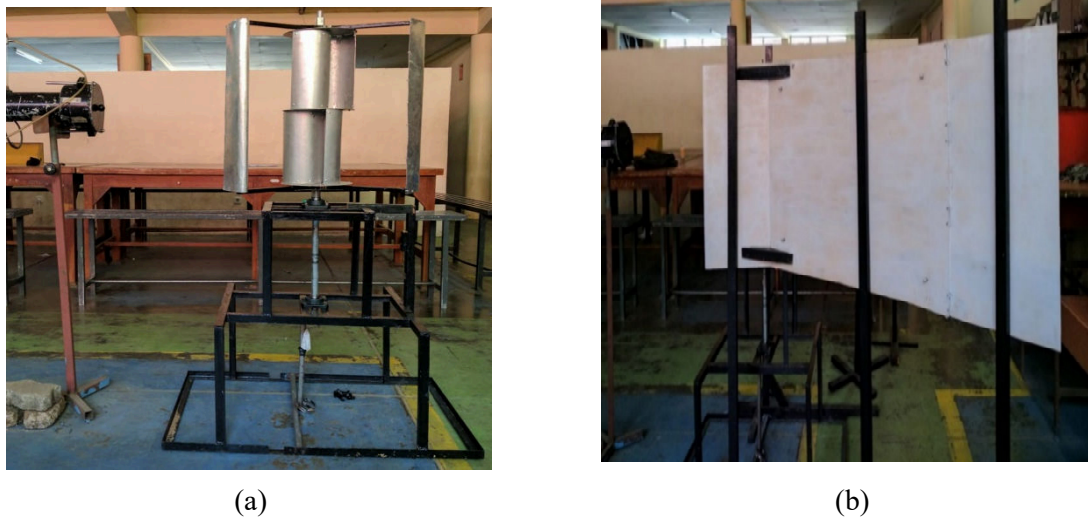
Gambar 4. Pengujian hybrid VAWT (a) tanpa flanged diffuser dan (b) dengan flanged diffuser di Laboratorium
