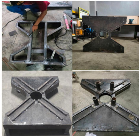
Gambar 2. Pembuatan Rangka dan Plat Dudukan Stand Transmisi D3C
