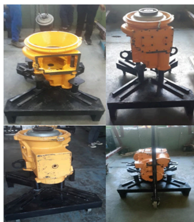
Gambar 4. Pengujian Stand Transmisi D3C
