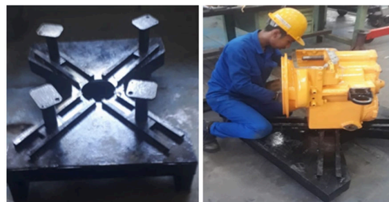
Gambar 3 Perakitan Stand Transmisi D3C
