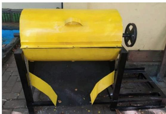
Gambar 3. Hasil Rancangan Mesin Pencacah Limbah Kayu
