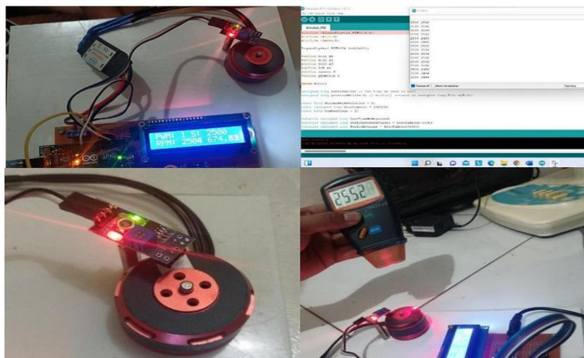
Gambar 2. Pengujian sensor Infrared dan pengaturan kecepatan motor BLDC
