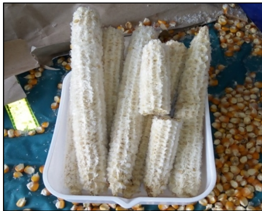
Gambar 6. Keadaan tongkol jagung setelah dipipil pada diameter 45 mm.
