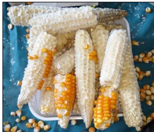
Gambar 4. Keadaan tongkol jagung setelah dipipil pada diameter 35 mm.
