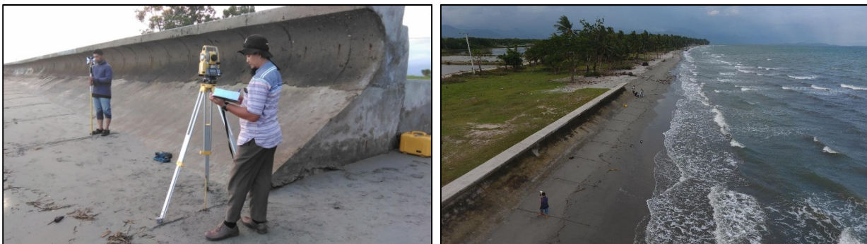
Gambar 2. Pengukuran potongan melintang garis pantai
