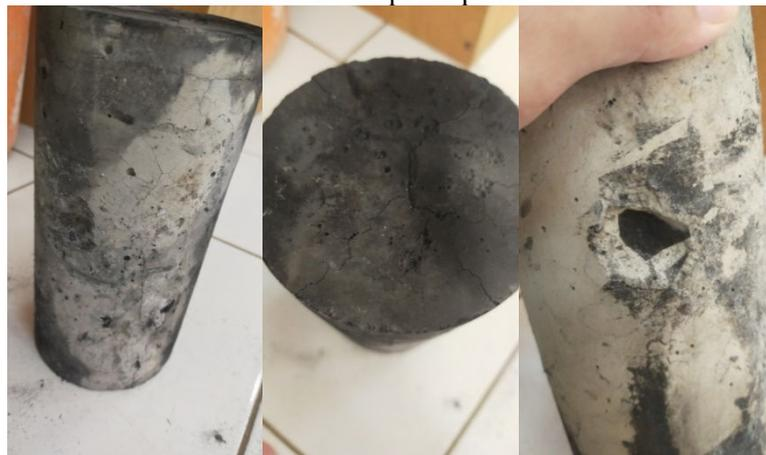
Gambar 3. Keretakan dan rongga pada beton pasca bakar
