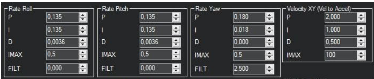
Gambar 4. Konfigurasi PID hasil tuning ulang
