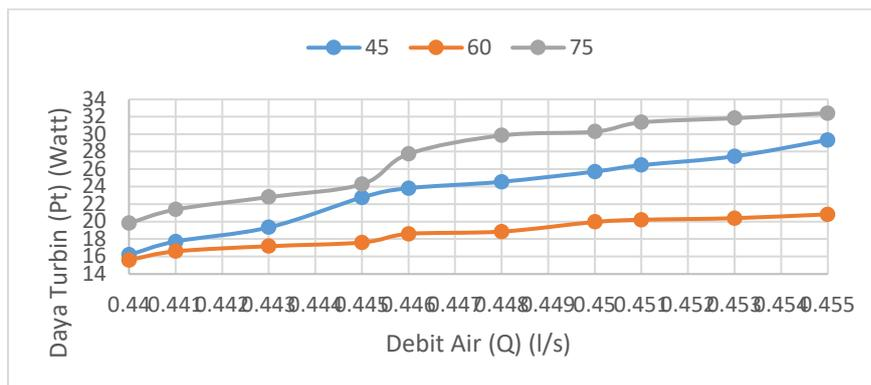
Gambar 4 1 Grafik hubungan debit air (Q) terhadap daya turbin (Pt) pada sudut nosel 5/8 inci
