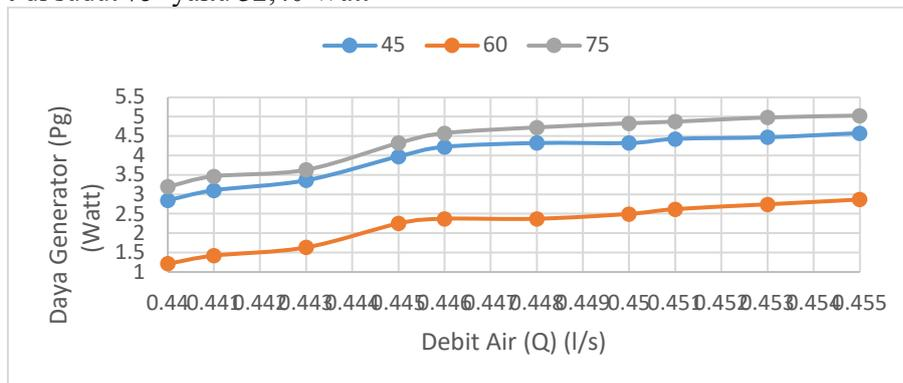
Gambar 4 2 Grafik hubungan debit air (Q) terhadap daya generator (Pg) pada sudut nosel 5/8 inci
