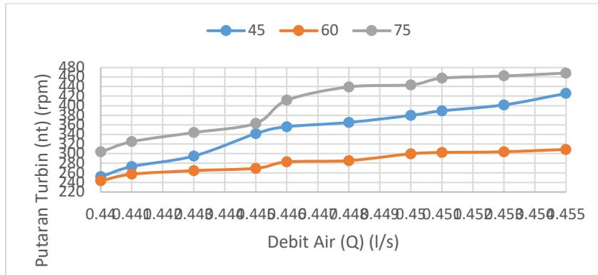
Gambar 5. Grafik hubungan debit air (Q) terhadap putaran turbin (nt) pada sudut nosel 5/8 inci
