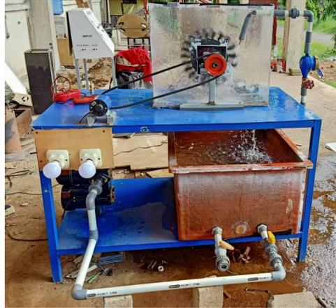
Gambar 2. Prototipe PLTMH Menggunakan Turbin Pelton
