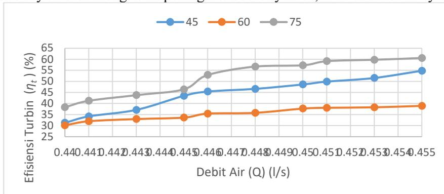
Gambar 4.3 Grafik hubungan debit air (Q) terhadap efisiensi turbin (η<sub>t</sub>) pada diameter nosel 5/8 inci
