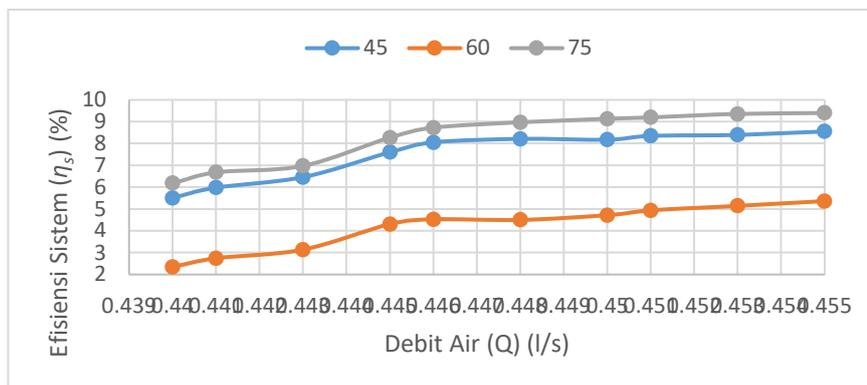
Gambar 4.4 Grafik hubungan debit air (Q) terhadap efisiensi sistem (η<sub>s</sub>) pada diameter nosel 5/8 inci
