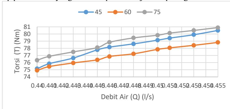
Gambar 4. Grafik hubungan debit air (Q) terhadap Torsi (T) pada sudut nosel 5/8 inci
