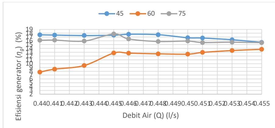
Gambar 4.5 Grafik hubungan debit air terhadap efisiensi generator ( $\eta_g$ ) pada diameter nosel 5/8 inci
