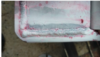
Gambar 12. Hasil Pengujian Penetrant pada Spesimen Uji Bending
